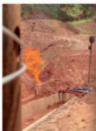
Desfogue presión acumulada después de pistoneo. P.acum. 260 psig.
